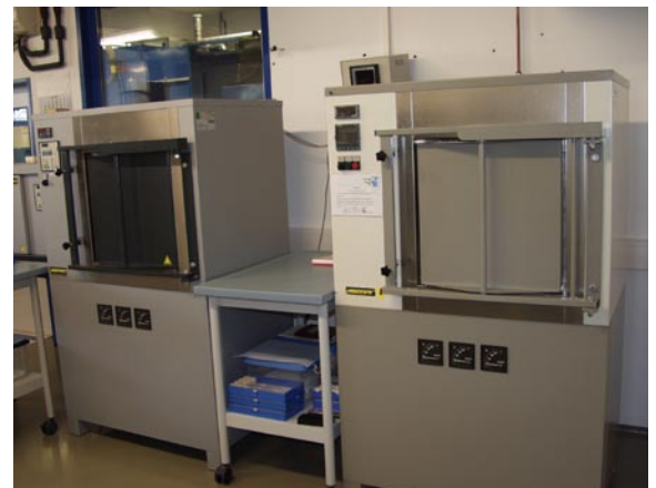
Abb. 12: Öfen für den Sinterbrand der Grünkörper.
